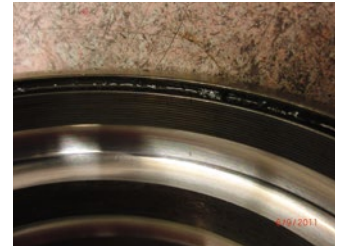
Mit Mikrotaktung keine Schäden erkennbar
